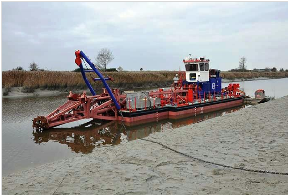
Figure 107 : Dragage aspiratrice (le cutter est visible en tête du bas aspirant)
