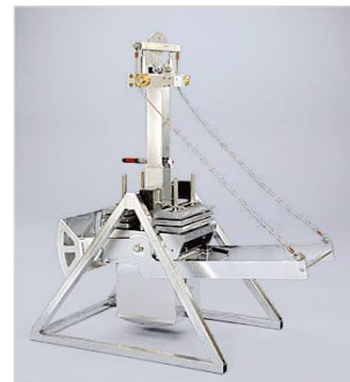
Figure 95 : Carottier à boîte « box-corer »
